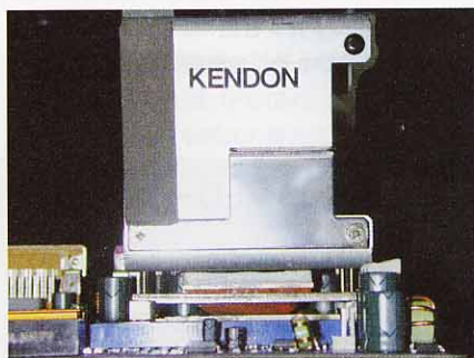
CPUコア、ピラミッドバフファ、ペルチェ、ラジエーターの順で熱が伝わる。コアの上面からラジエーター本体まで、14mmのクリアランスがあるため、マザーボード上のパーツに干渉しにくい
